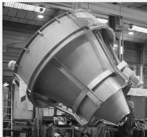
De construction robuste, les filtres / tamis vibrants **SAT** et **SAT COMPACT** sont utilisés pour la **séparation et la classification de produits secs** ainsi que la **séparation solide/liquide**.
