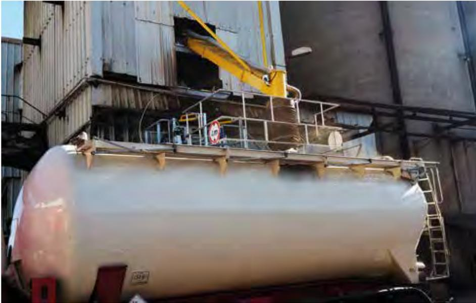
l'objectif du projet était d'assurer le chargement des camions via une manchette télescopique accessible aisément une fois l'arceau descendu. Il fallait aussi assurer le bon positionnement de la manchette par rapport au trou d'homme jusqu'au-dessus du camion et éviter au passage la diffusion de poussière via un système de cône.
