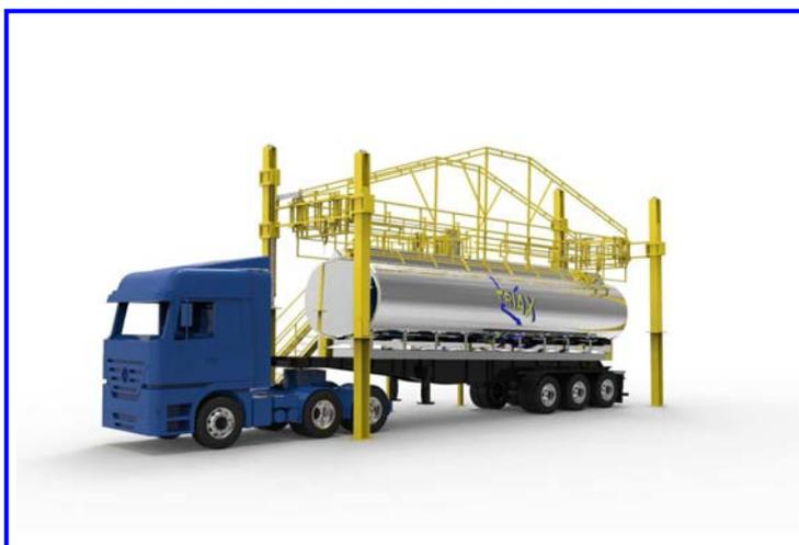
Lorsque le camion est stationné, le garde-corps, commandé par des vérins pneumatiques que l'opérateur commande depuis un coffret situé sur la plate-forme, est mis en place et ajusté. Il est capable de s'adapter à pratiquement toutes les dimensions de citerne (6 à 13 mètres de longueur ; 2,8 à 4,1 mètres de hauteur).
