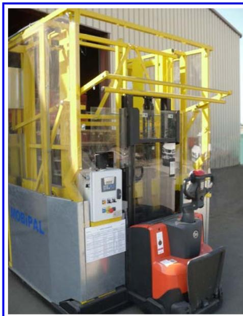
Il peut être également utilisé en tant qu'empileur afin de constituer une pile, en prélevant des palettes éparpillées au sol à divers emplacements.
