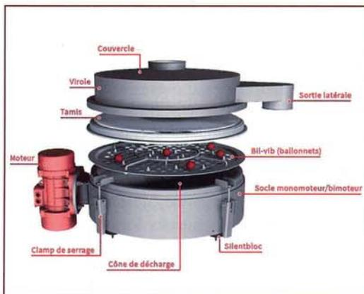
50 t./h. Il est équipé d'un système de démontage rapide et sans outil avec clamps de serrage et d'un système de décolmatage à ultrasons. Ne présentant pas de zone de rétention, il est utilisé pour le tamisage de sécurité exclusivement et l'élimination d'impuretés notamment par les industries alimentaires et pharmaceutiques ainsi qu'à la métallurgie des poudres (version Atex en option).
